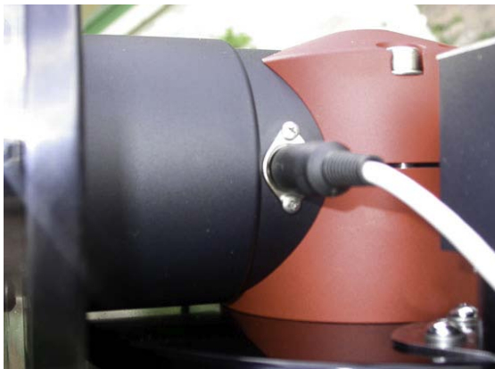
Connettori encoder DEC e AR
